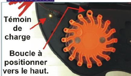
**MISE EN CHARGE :** Placez de 1 à 6 balises dans les empreintes au fond de la valise avec les vis vers le bas, en contact avec les connecteurs. La boucle de la balise sert de détrompeur pour la bonne position. Les balises doivent être stabilisées par leurs aimants.
