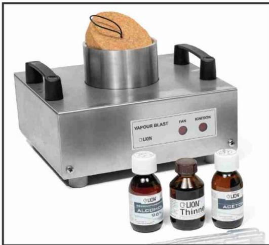
Lorsqu'elles sont présentes dans des proportions adéquates, les traces inoffensives de substances inflammables peuvent provoquer des explosions intenses. Le Vapour Blast permet de montrer comment une substance inflammable et de l'oxygène (air) peuvent générer un environnement explosif lorsqu'ils sont présents en quantité suffisante.
